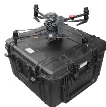
DJI MATRICE 30T Telecamere grandangolari, zoom e infrarossi integrate con sensore a telemetro laser per ispezioni termografiche
