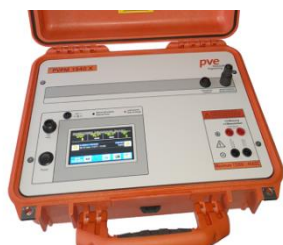
PVPM1540X Strumento multifunzione avanzato per misure di Curve I-V fino a 1500V e 40A
